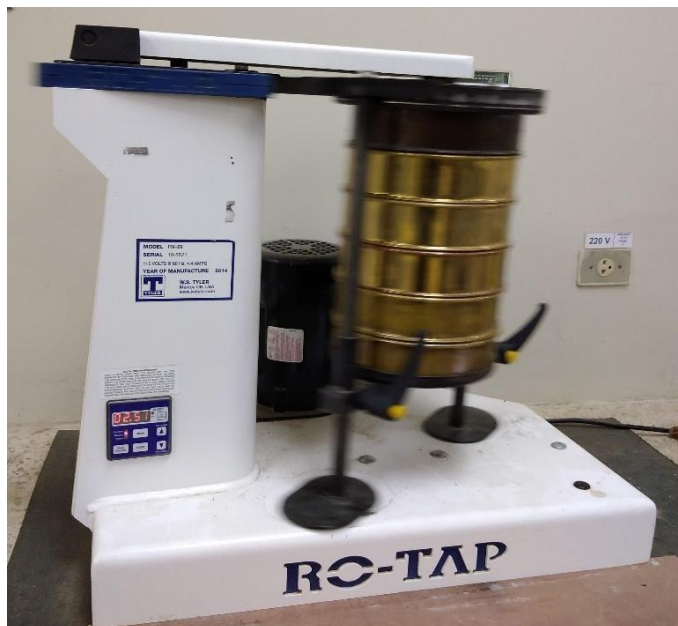
Figura 2.13: Tamizador Ro-Tap marca WS Tyler modelo RX-29 [Laboratorio de geotecnia de la FICT – ESPOL]
