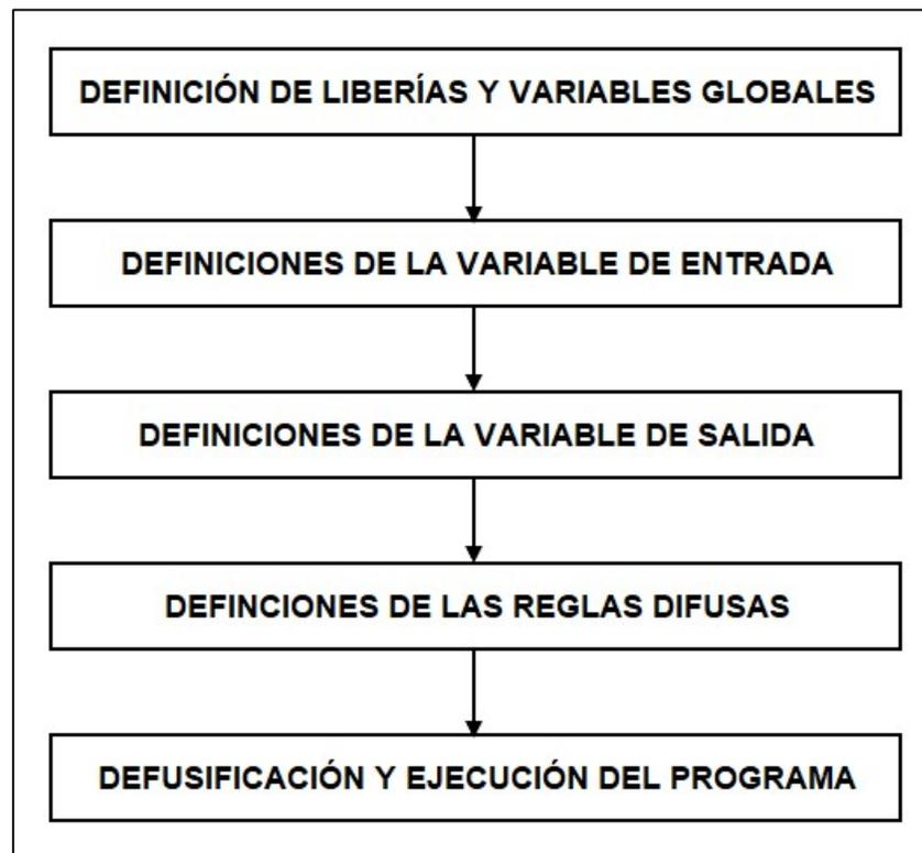
**Figura 3.80 Proceso del controlador difuso de temperatura.**
