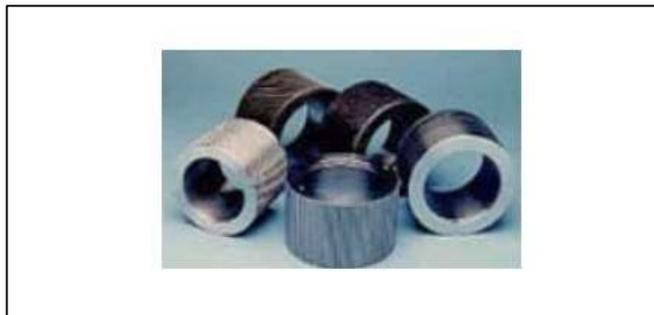
**Figura 2.4 Rodillos de una Peletizadora. [2]**
