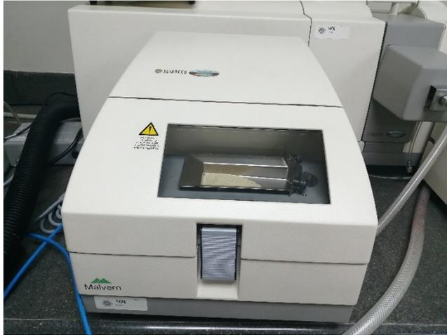
**Figura 2.1 Medidor de tamaño de partícula, MASTERSIZER.**
