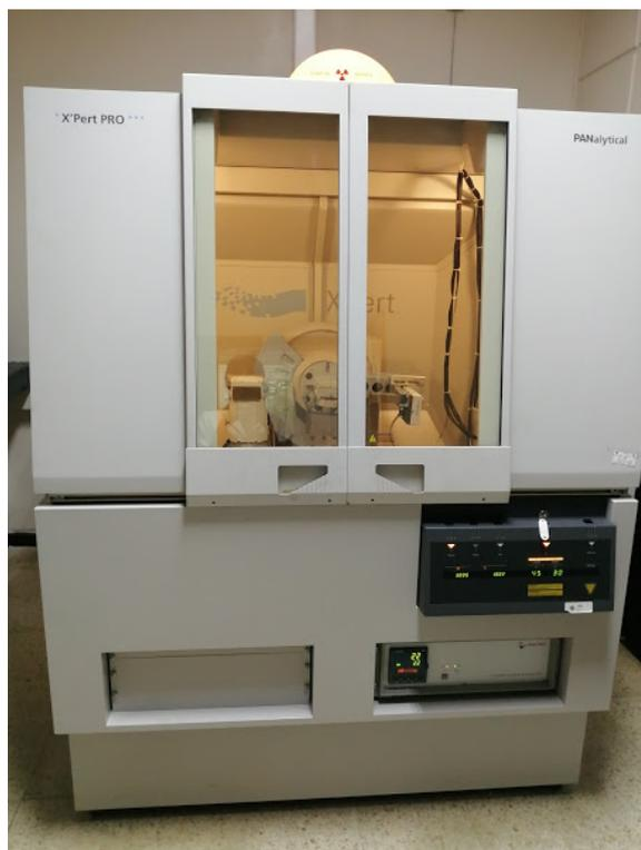
**Figura 2.7 Equipo de difracción de rayos x.**
