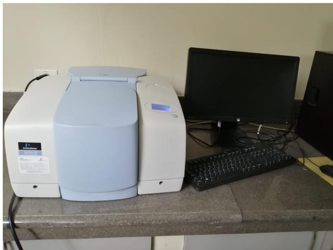
**Figura 2.6 Equipo de espectroscopía infrarroja de Fourier.**
