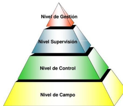
Figura 3: Pirámide de Automatización
