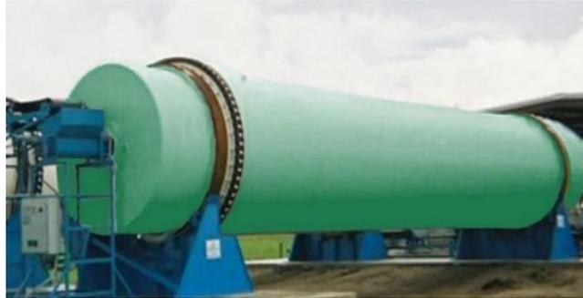
**Figura 1.6 Bioreactor para compostaje (Ison21, 2019).**
