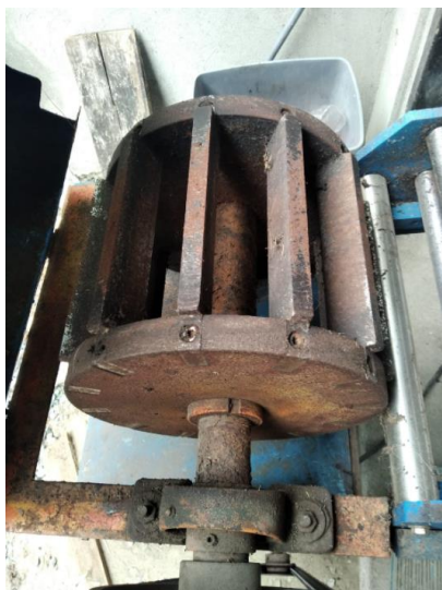
Figura 2.8 Tambor desfibrador. [Fuente: INPADESA]
