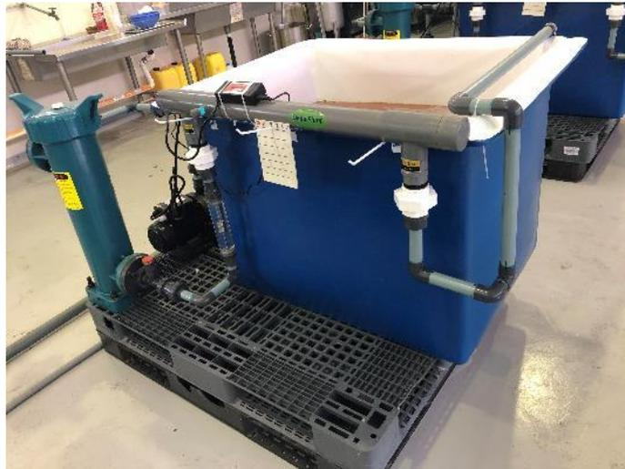
**Figura 3.12 Prototipo a nivel de laboratorios tanques del sistema de Depuración**
