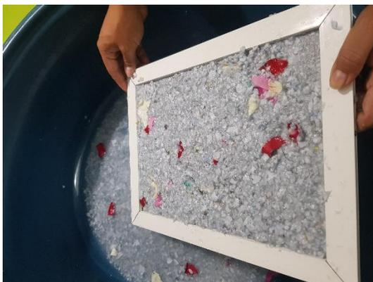
**Ilustración 13** Tamizado de la pulpa celulosa
