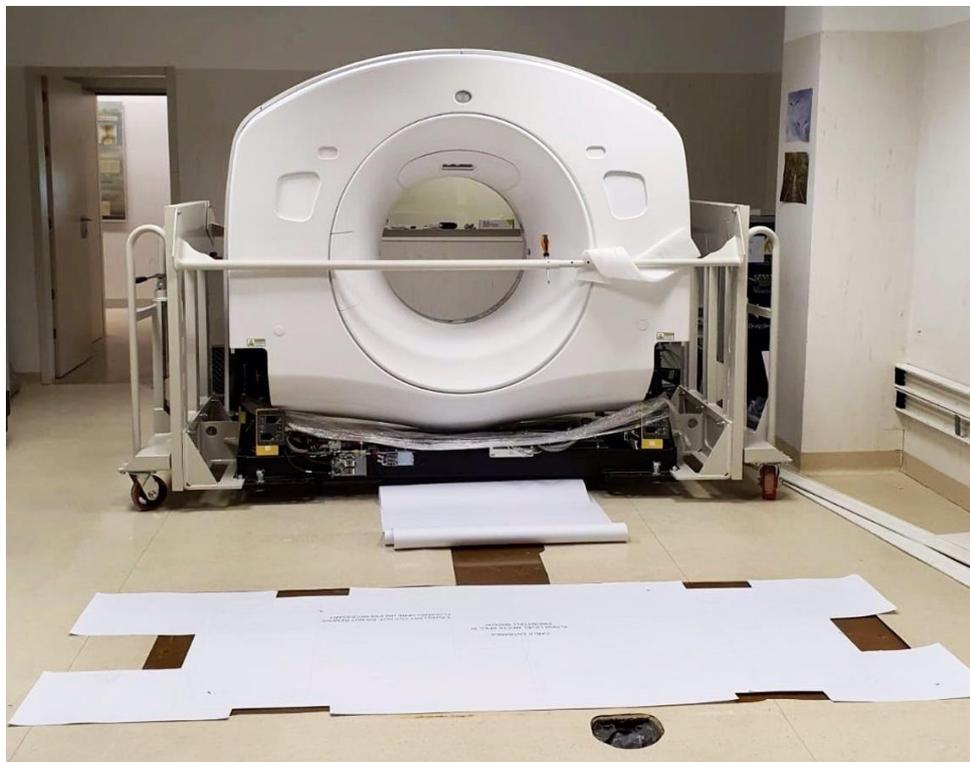
**Figura 4.3** Gantry sobre ruedas soporte de traslado, [34]
