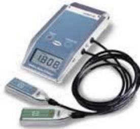
El UnforsMult-O-Meter es un multiparámetro de metro de rayos X que fácilmente se adapta a su bolsillo. El detector de pequeñas medidas kVp externa, dosis, tasa de dosis y el tiempo simultáneamente. El medidor es ideal para mediciones rápidas, tales como control de calidad diario de verificación de los equipos convencionales en el rango de 50-150 kV.
