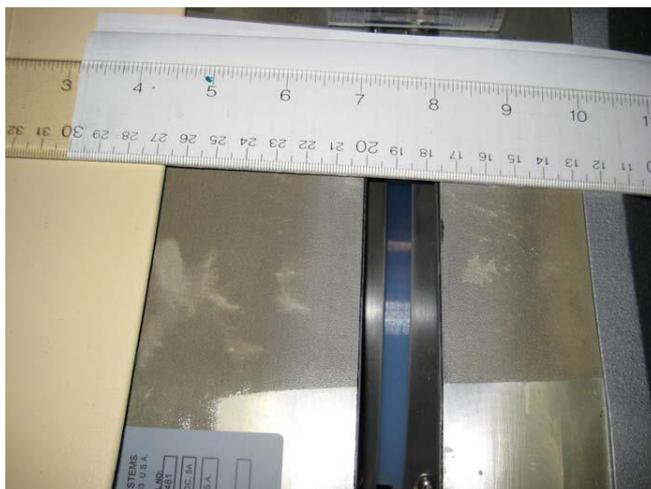
Figura 6-13: Comprobación de la apertura de la cuchilla de colimador con una regla
