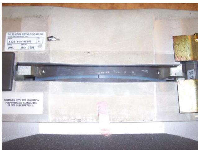
Figura 6-3: Crack visto en el compensador de colimador
