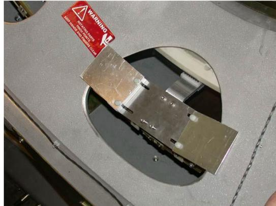
Figura 6-4: Instalación de la herramienta de limpieza de deslizamiento
