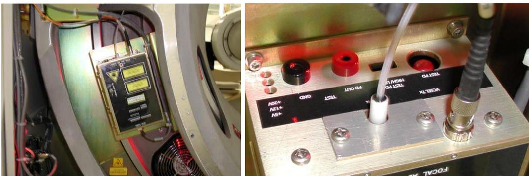
Figura 6-8: Ubicación y conexiones de la caja del módulo RX del receptor óptico (BR 6/10/16-slice, 16 Power)
