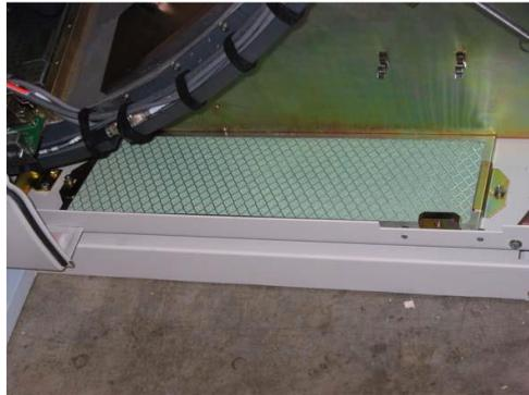
4. Retire y limpie los filtros de aire. Los filtros se pueden limpiar aspirando, enjuague con agua fría o soplando con aire comprimido. Use lentes de seguridad cuando use aire comprimido.
