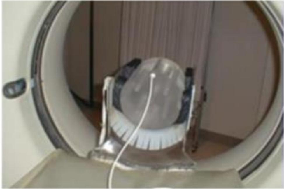
**Figura 6.6 Ubicación de cámara de ionización en el phantom para determinación de índice de dosis volumétrico, [5]**
