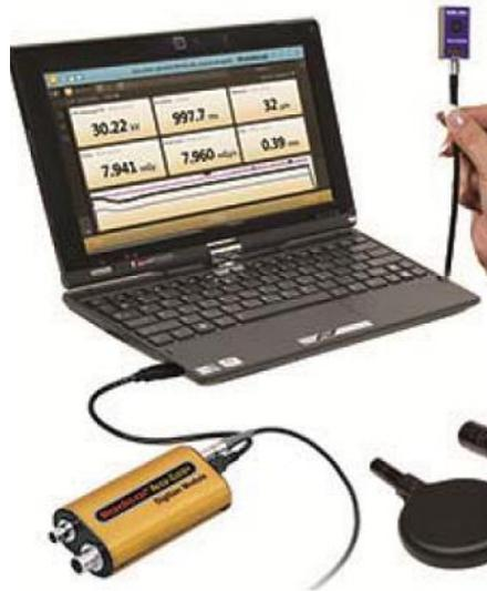
Este instrumento consta de con 2 sondas de medición directas y un clamp para medir KV, DOSIS, TIEMPO, MA, MAS,
