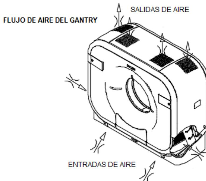
Figura 3.7 Sentido del flujo de aire del gantry, [31]
