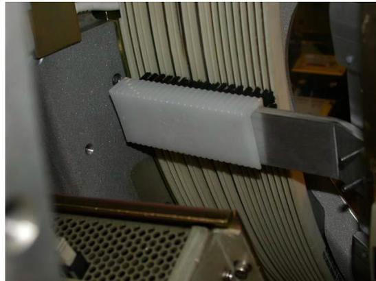
Figura 6-5: Cepillo de limpieza deslizante montado en la herramienta de limpieza de rodillos (mostrado desde abajo el rotor)
