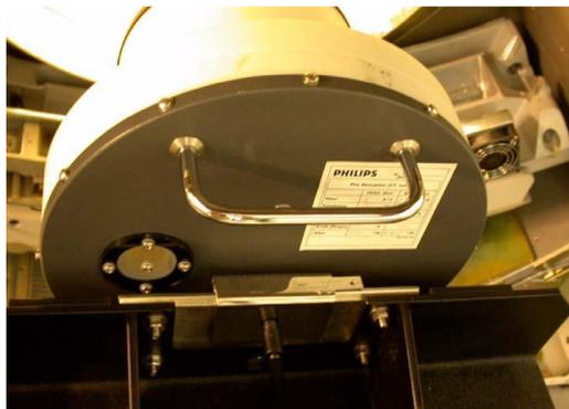
Figure 6.5.1 Phantoma de sistema alineado con el láser al filo del soporte de calibración y encerada la posición de la mesa
