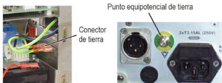
**Figura 4.69** Terminales de conexión a tierra dentro y fuera del equipo. [96] [60]
