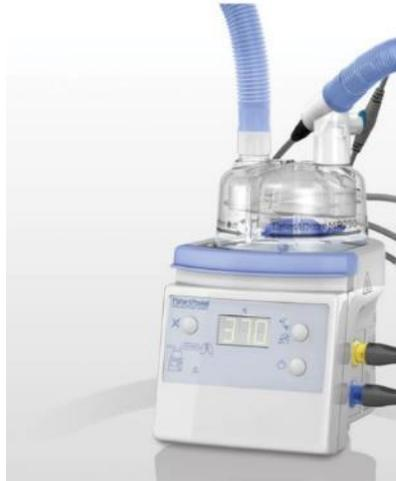
**Figura 4.76 Humidificador servo controlado Marca Fisher&Paykel. [114]**
