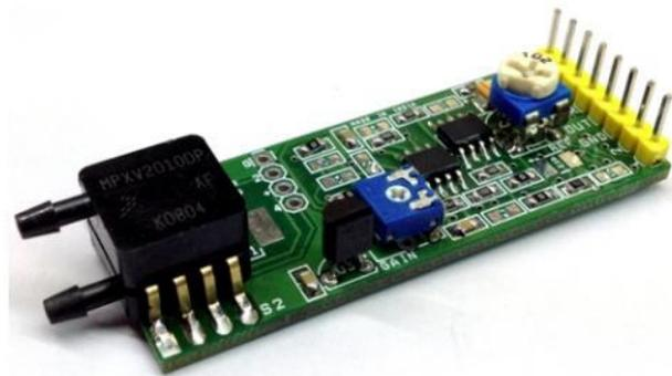
**Figura 4.48 Tarjeta amplificadora para sensor de presión. [88]**
