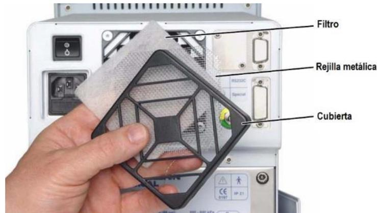
**Figura 4.44 Filtro de entrada de aire con cubierta y rejilla. [60]**
