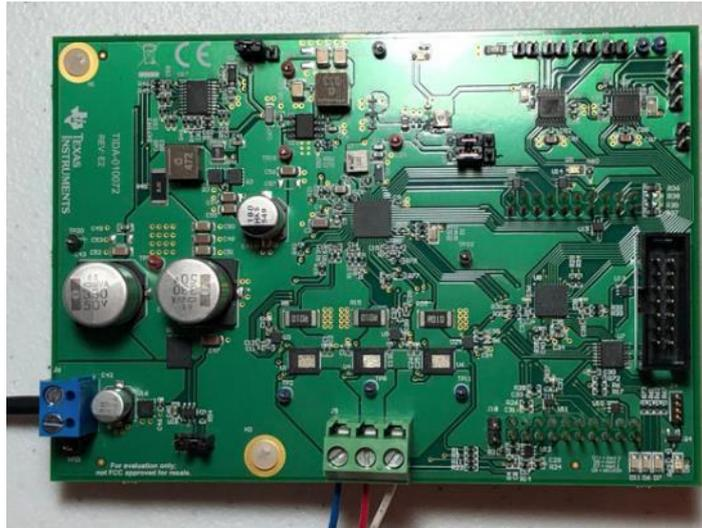
**Figura 4.47 Tarjeta TIDA-010072 para control de válvulas y blower. Marca Texas Instruments. [87]**
