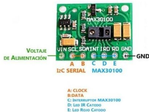
Figura 25 Representación de los pines del sensor MAX30100
