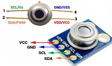
Figura 24 Representación de los pines del sensor MXL90614
