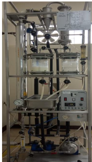
Figura 3.1 Evaporador de película ascendente alimentado con leche ubicado en el Laboratorio de Investigaciones y Desarrollo de Alimentos de la FIMCP-ESPOL
