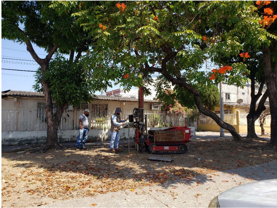
Figura 3.1. – Ejecución de disipación de presión de poros en CPT-11 (Sector Sauces)
