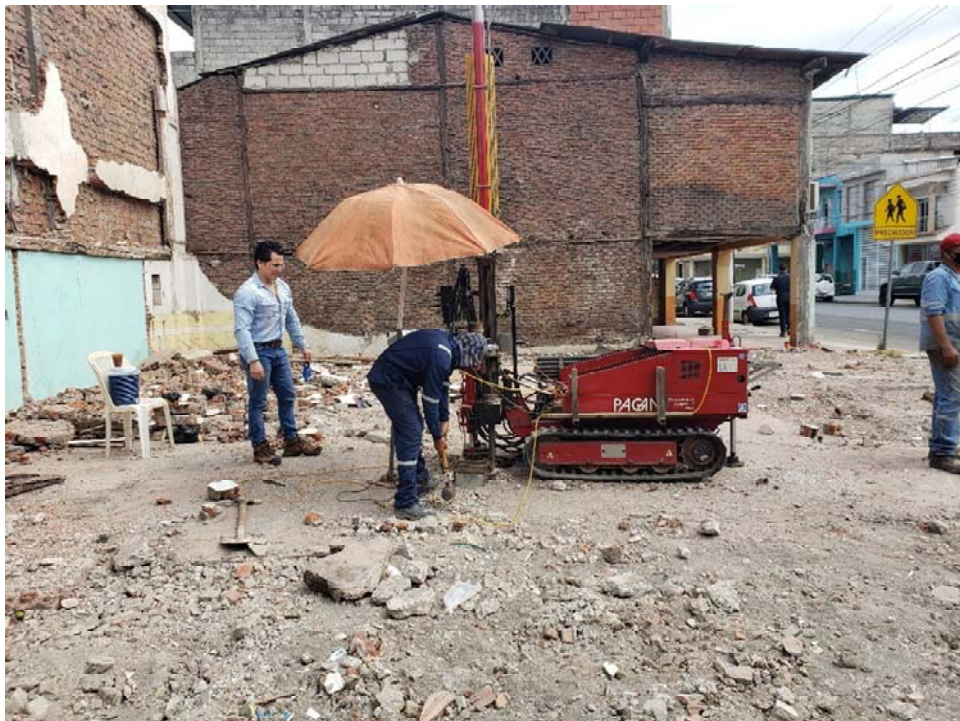
Figura 3.2. – Medición downhole de v_s en CPT-34 (Calle Bolivia y Tungurahua)
