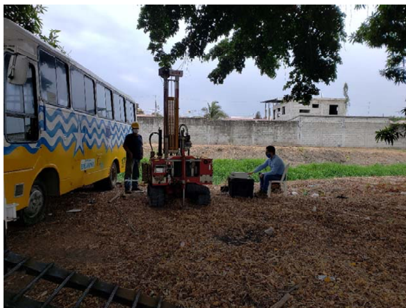
Figura 3.4. – Medición de veletas de campo en CPT-VST-13 (Sector Samanes)
