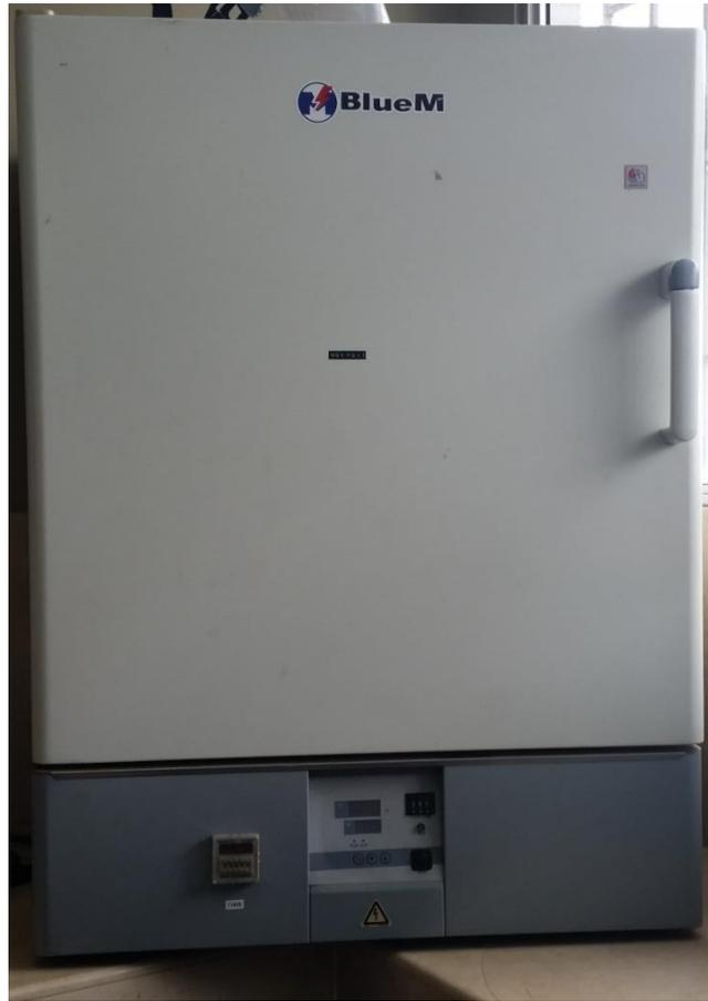
**Figura 47:** Equipo de Choque Térmico
