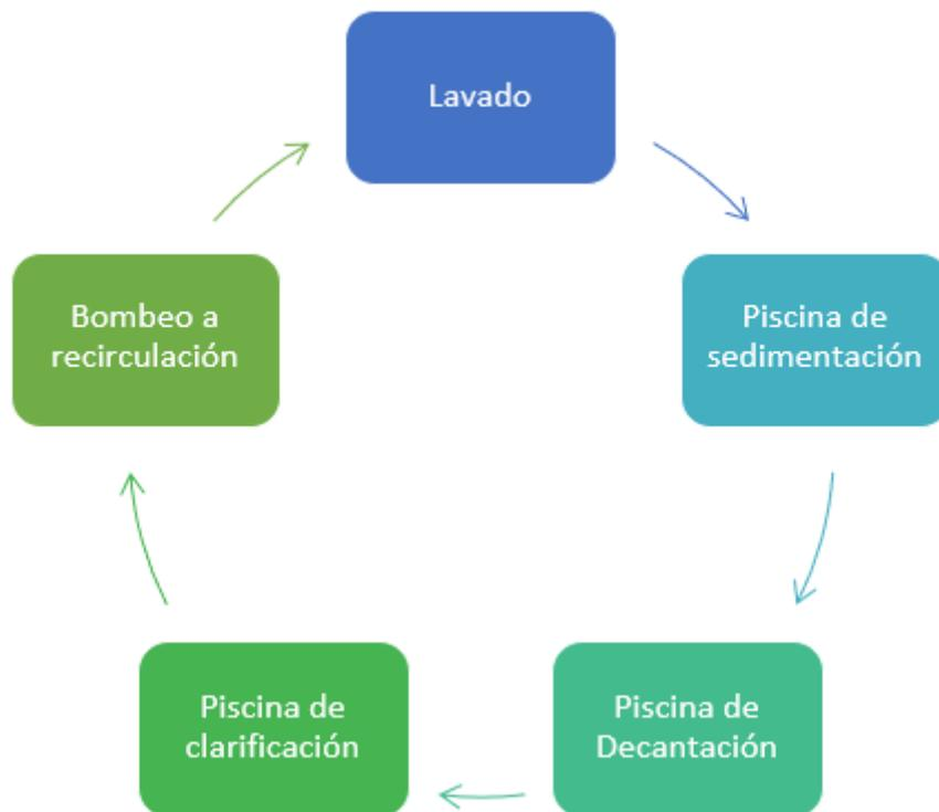
**Figura 3.12** Esquema de proceso de utilización del agua y su circulación
