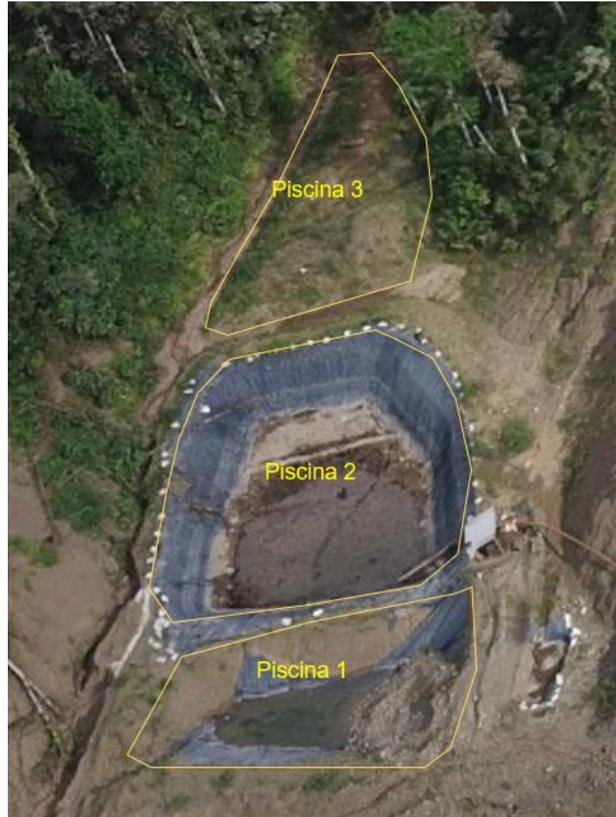
**Figura 3.13** Piscinas de sedimentación, decantación y clarificación del agua y su circulación
