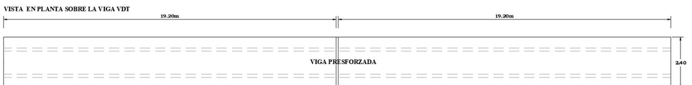
**Figura 5-28** Vigas doble t de 19.20m cada una, autores.
