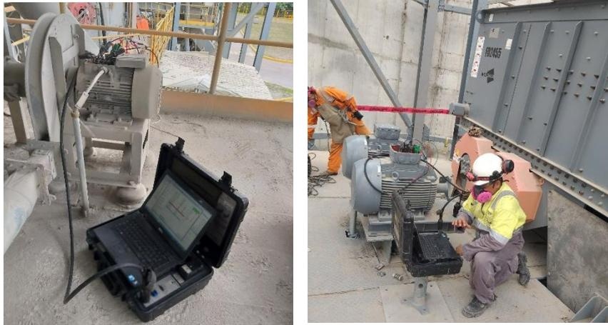
**Figura 4.14 Medición con el equipo PdMA**
