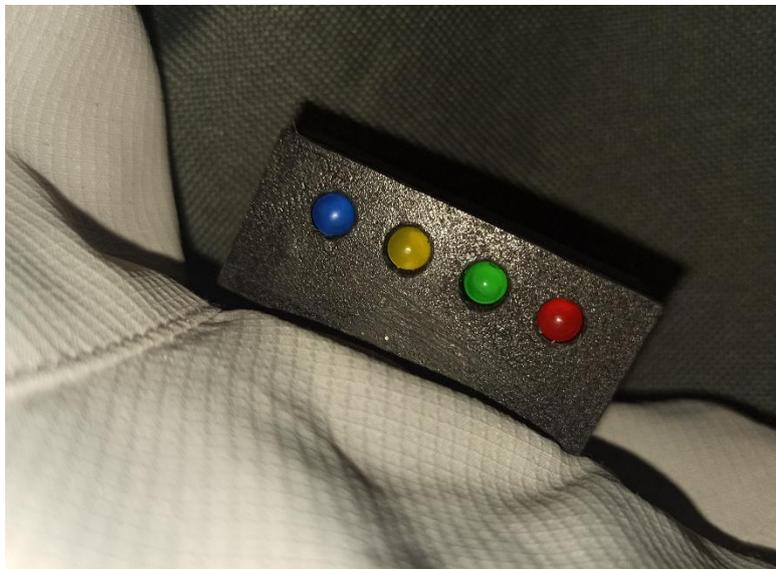
**Figura 3.41** Instalación de la PCB de leds por medio de soportes 3D
