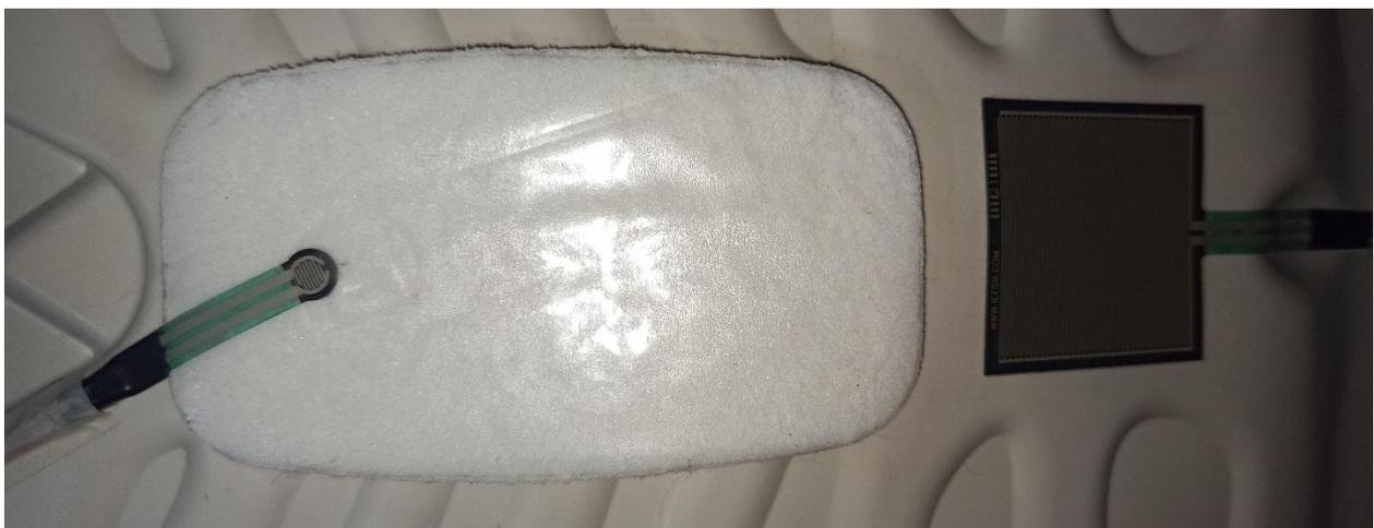
Figura 3.38 Instalación de los sensores de fuerza para corazón y pulmón.
