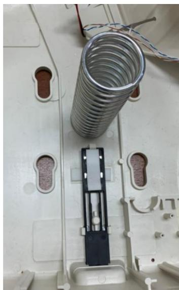
**Figura 2.5 Sistema de compresión**
