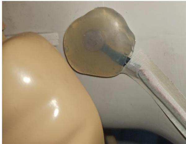
**Figura 3.40** Instalación del motor vibrador tipo pastilla.
