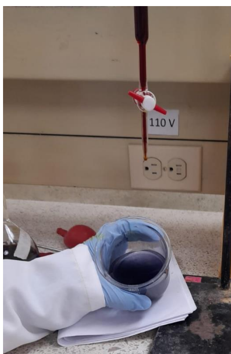
Figura A. Coloración resultante luego de aplicar volumetría para la determinación de ácido ascórbico.
