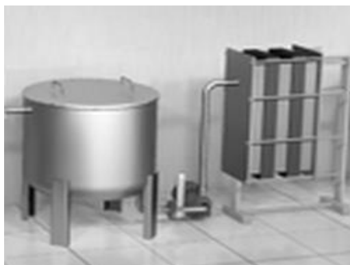
Ilustración 4.6 - Tanque de Reserva de Pre-enfriamiento / Placas de Enfriamiento
