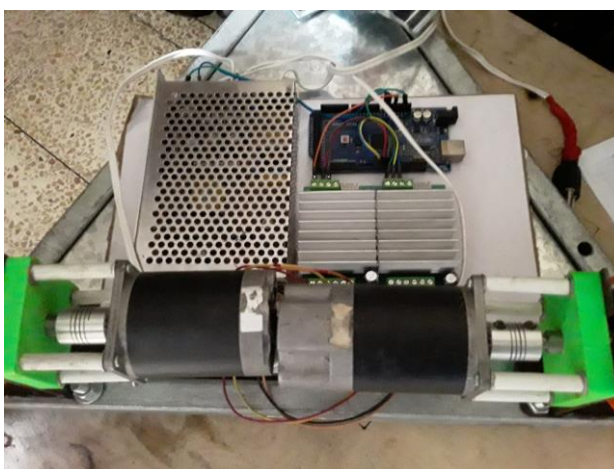
Figura 3.9: Motores de paso, drivers, fuente de prueba y tarjeta de control [Fuente propia].
