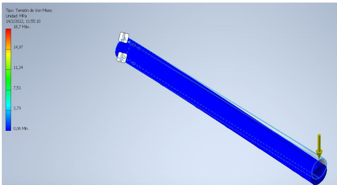
**Figura 3.7 Analisis de elementos finitos del brazo del rotor desplazamiento de Von Mises**
