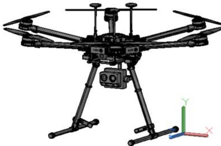
**Figura 3.1 Modelo del hexacóptero en AutoCAD**
