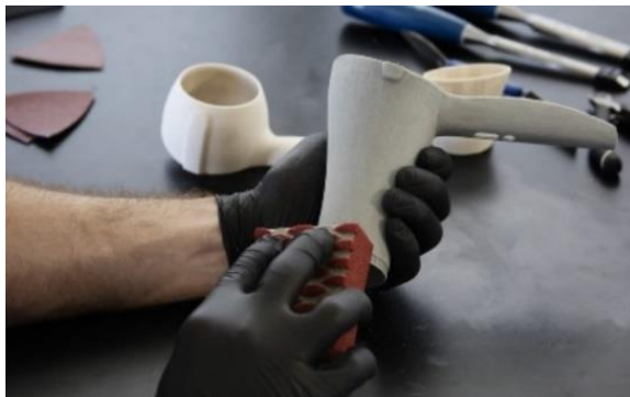
Figura 1.2 Postproceso a una pieza impresa en 3D por medio del uso de papel lija para un mejor acabado superficial [4]
