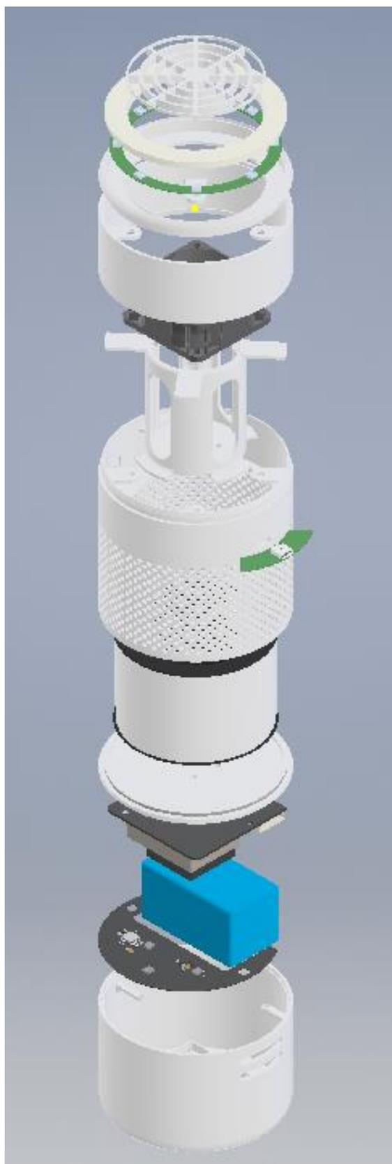
**Figura 3.2 Vista explosionada de todos los componentes incluidos en el diseño mecánico**
