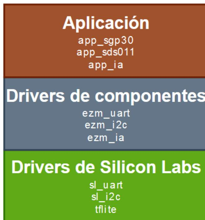
Figura 3.43 Capas del sistema embebido
