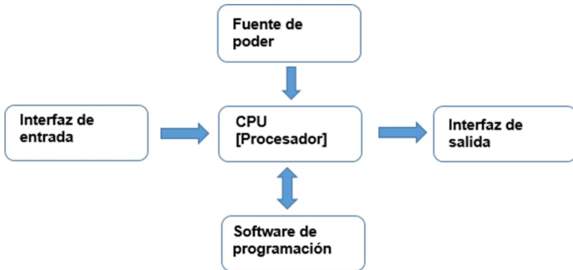
**Figura 1.4 Modelo de PLC [Elaboración Propia]**
