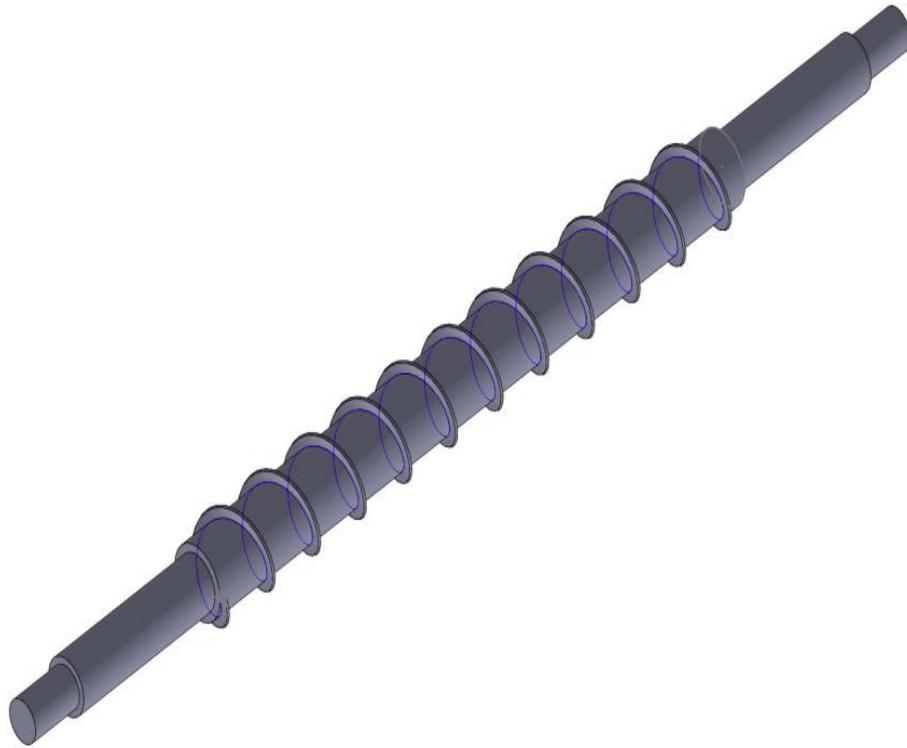
**Figura 2.2** Diseño inicial de eje para el descascarado del grano de arroz (Elaboración propia).
