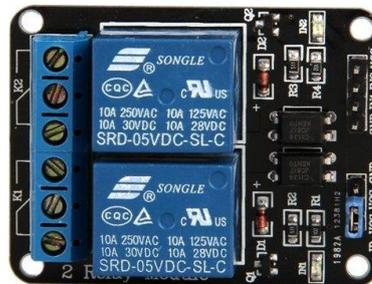
Figura 3.8 Módulo Relé de 5V para RPi y Arduino
