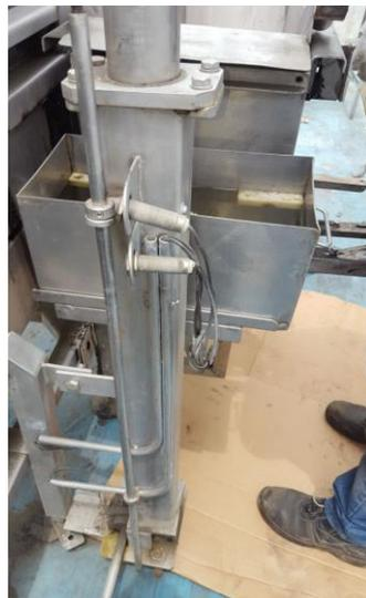
**Figura 4. Sensores inductivos para elevación de campana**
