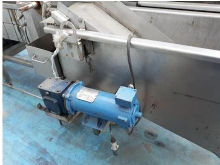
**Figura 3. Motor de banda de desperdicios**
