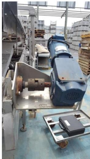
Figura 2. Motor de bandas averiado(remplazado)
