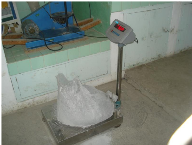
FIGURA 19. Dosificación de los materiales. Pesado de el cuarzo molido
