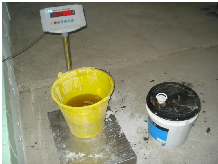
FIGURA 21. Dosificación de los materiales. Pesado de el aditivo superplastificante.
