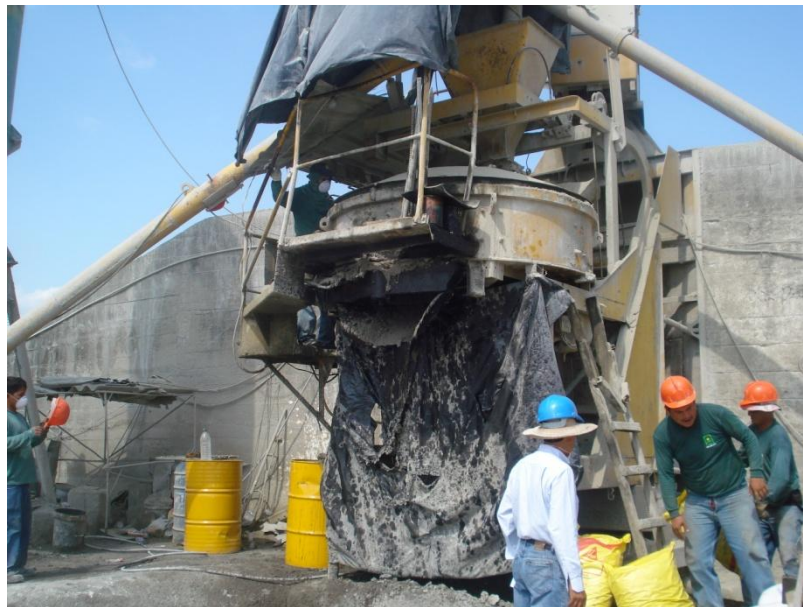
FIGURA 22. Dosificadora – Mezcladora. Capacidad aproximada 0.25 metros cubicos.
