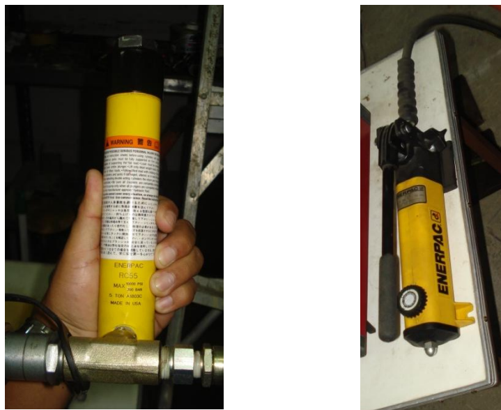
FIGURA 30. Gato hidráulico Enerpac capacidad 5 ton.
