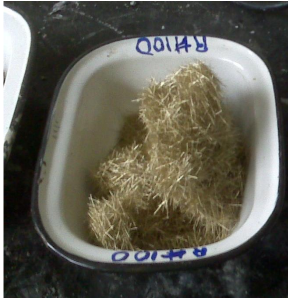
FIGURA 28. Fibra metálica Bekaert OL13 0.16.
