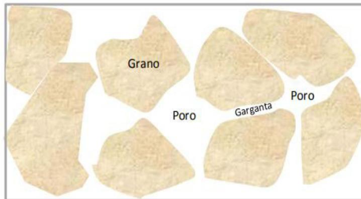
**Figura 1.1. Esquema de un Sistema Poral**
