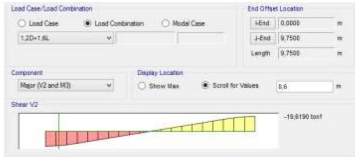
**Figura B. 28 Determinación del cortante  $V'u$**
