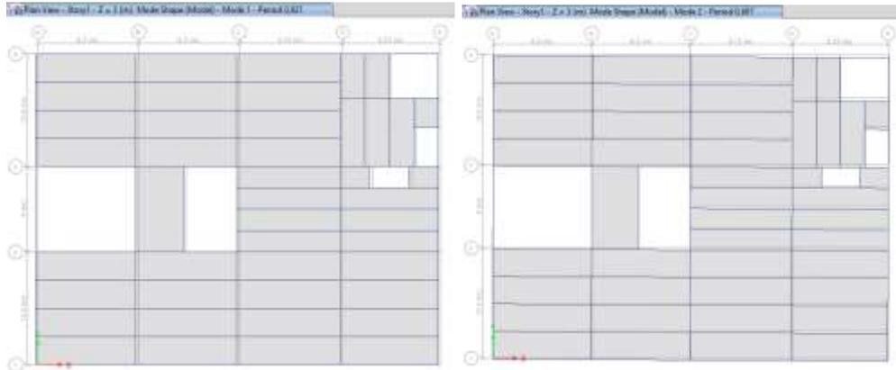
**Figura B. 30 Primer periodo de vibración,  $T_x=0.921$  seg. Segundo periodo de vibración,  $T_x=0.687$  seg, Fuente: ETABS 2015**
