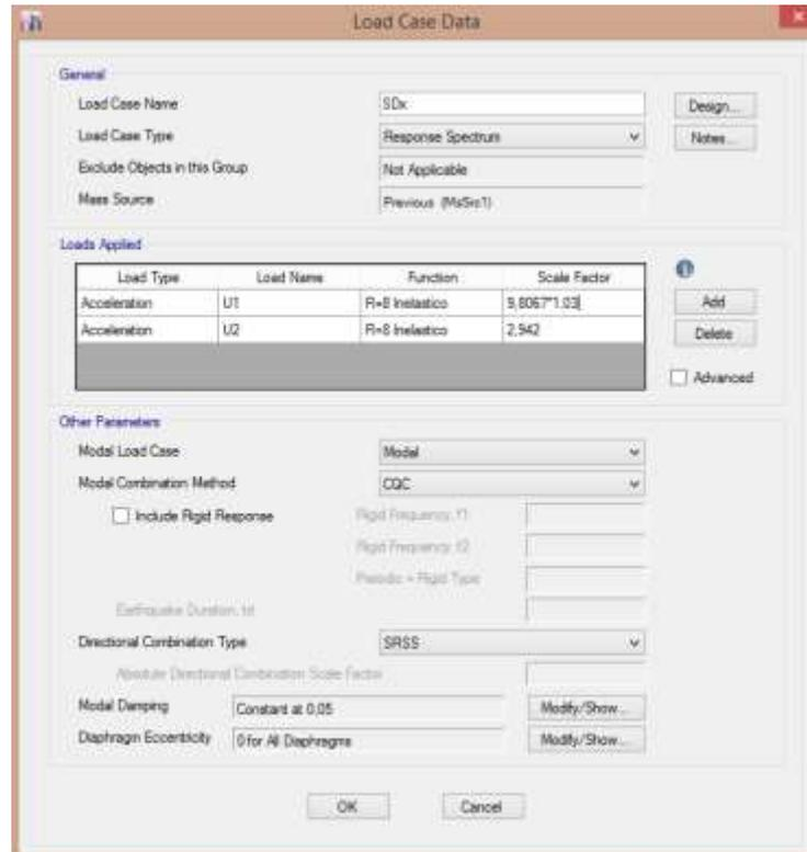
Figura B. 26. Factor de ajuste del cortante basal dinámico. Fuente: ETABS 2015.
