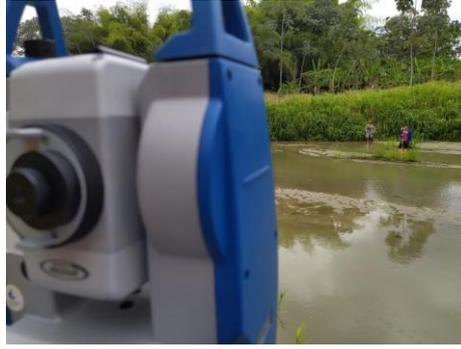
**Figura 0.3. Topografía mediante estación total**
