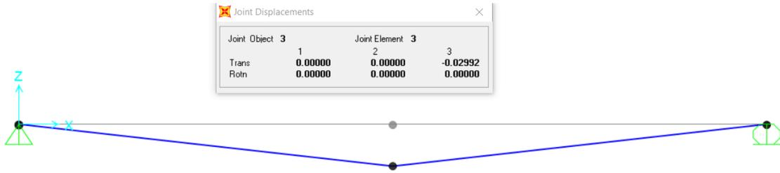
**Figura 0.45. Deflexión por sobrecarga distribuida (Tramo 1)**
