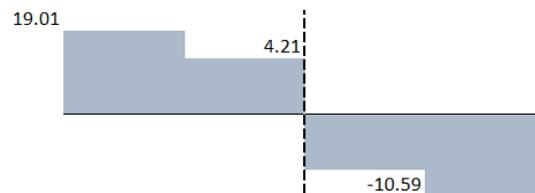
Figura 0.31. Diagrama de cortante por carga viva máxima en el centro del claro para Tramo 2
