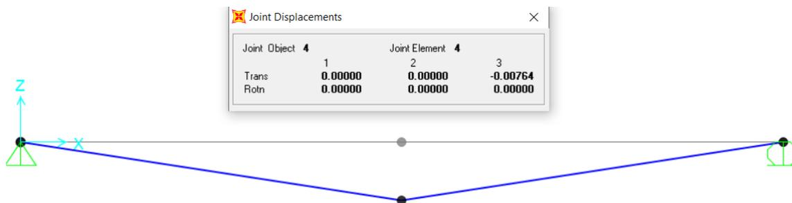
**Figura 0.47. Deflexión por sobrecarga distribuida (Tramo 2)**
