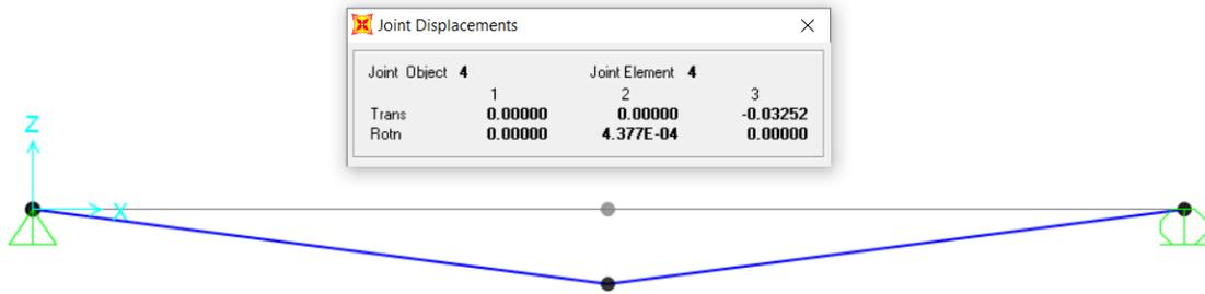
**Figura 0.48. Deflexión por sobrecarga del camión HL-93 (Tramo 2)**
