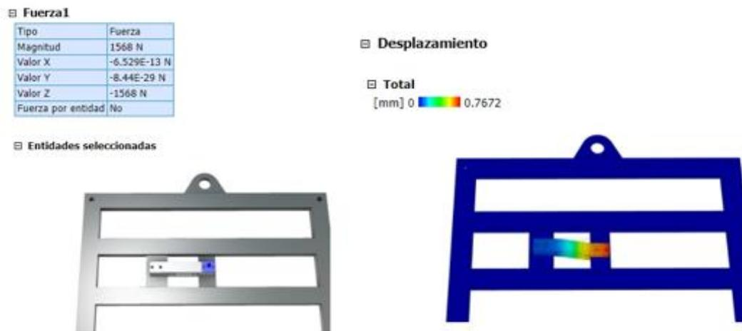
Figura 3.5. Análisis de elemento finito de la celada de carga.
