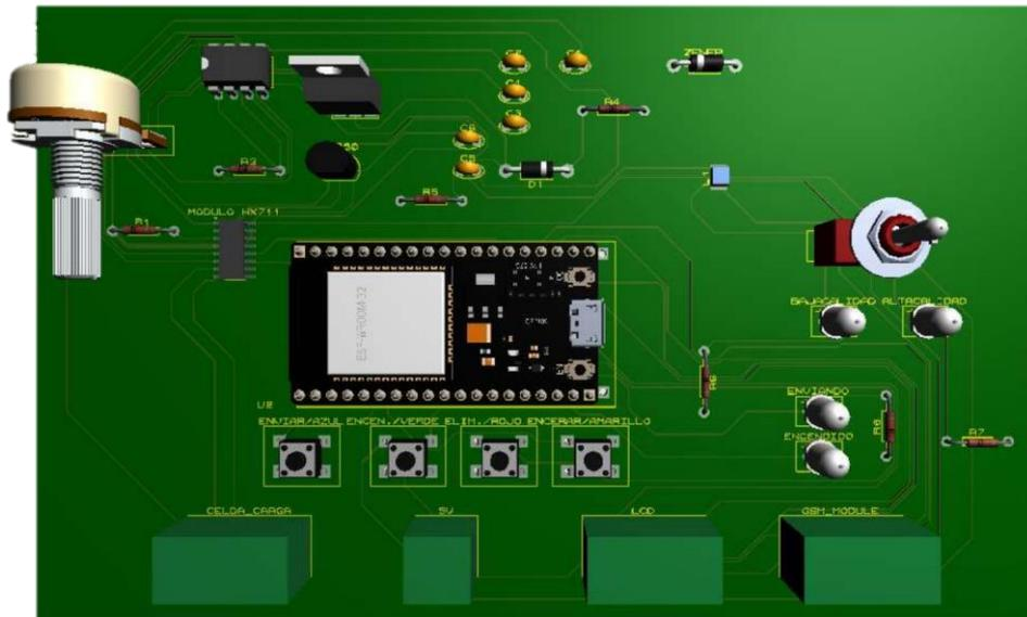
Figura 3.14. Placa PCB del circuito de la balanza.
