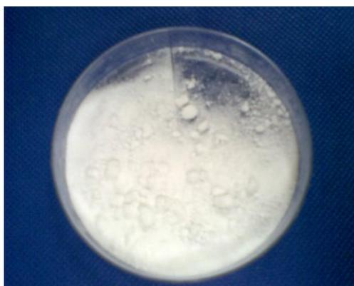
**Figura 3.9.- Alumbre de potasio, filtrado y secado.**
