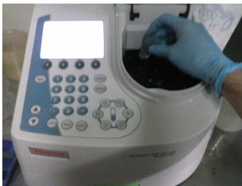
**Figura 3.5.- Espectrofotómetro.**
