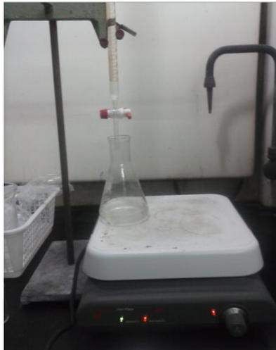
**Figura 3.6.- Sistema de precipitación para el alumbre de potasio.**
