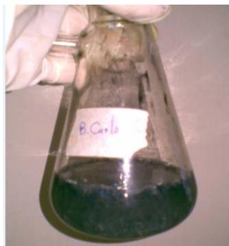
**Figura 3.4.- Solución obtenida de la disolución de los desechos de blíster.**
