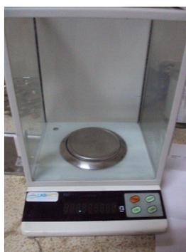
**FIGURA 3.7. BALANZA ANALÍTICA DIGITAL**
