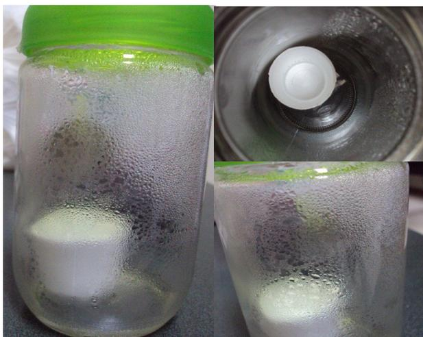
**FIGURA 4.22. RECIPIENTE DE VIDRIO DESPUES DEL CLICO DE HUMEDAD**
