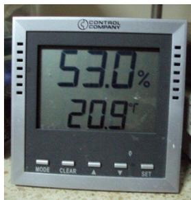
**FIGURA 3.6. HIGRÓMETRO DIGITAL**
