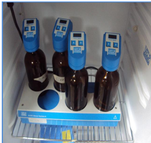
Sistema para la incubación DBO (5 Días)
