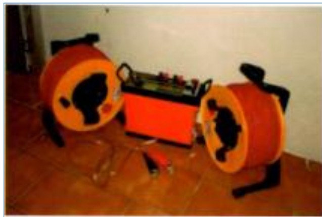
Figura 4.6. Resistivímetro terrameter, utilizado para estudio geoelectrico.
