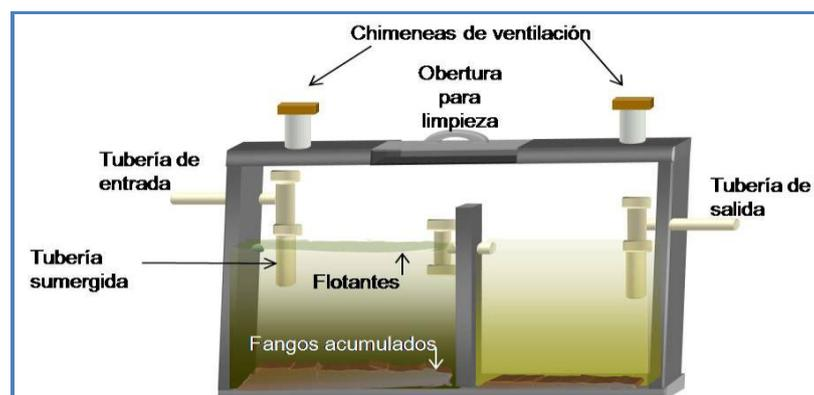
Figura 6.3. Sección Transversal de Fosa Séptica de dos Compartimientos
