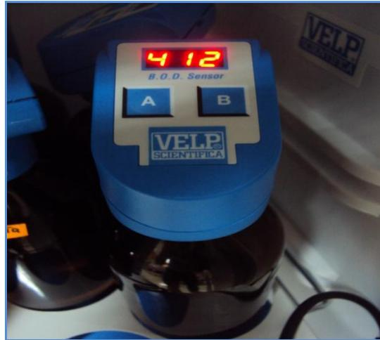
Botellas y manómetro de DBO
