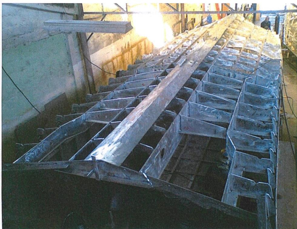
**Figura 1.2: Construcción de la lancha LP-AST 1304, [7]**
