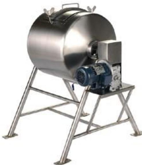
Figura 4-1: Homogenizador
