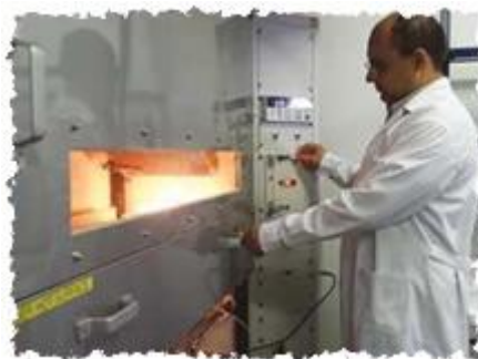
Figura 4.17. Prueba de resistencia al fuego
