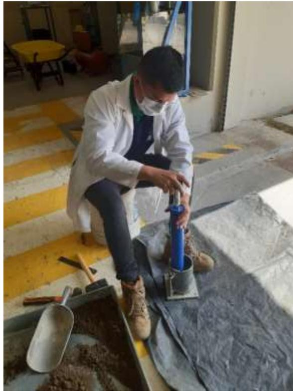
**Figura 3.6:** Realización del ensayo de proctor estándar
