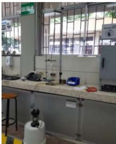
**Figura 3.9:** Saturación de la muestra previo al ensayo de permeabilidad
