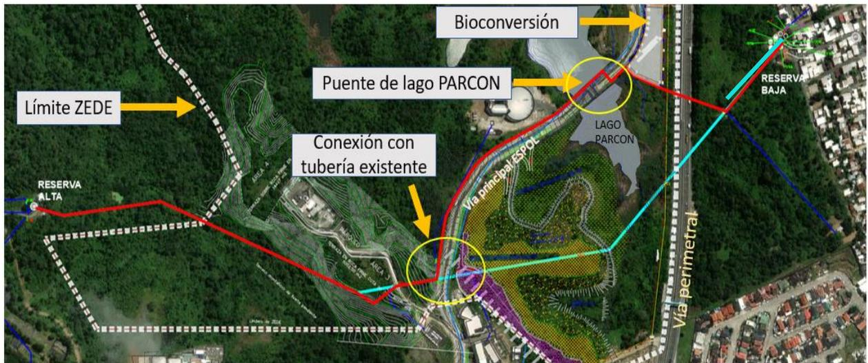
Figura 2.18 Alternativa 3: Excavación sin zanja [Chávez & Ramírez].
