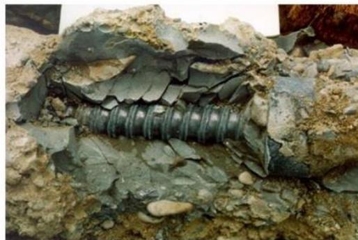
El anclaje continuo inyectado es una alternativa que por si sola brinda nada más soluciones de estabilización de suelos, pero debido a que la finalidad del presente proyecto es diseñar los cimientos portantes de una estructura, la configuración total de la alternativa se complementa en conjunto a las soluciones de cimentación tradicionales.
