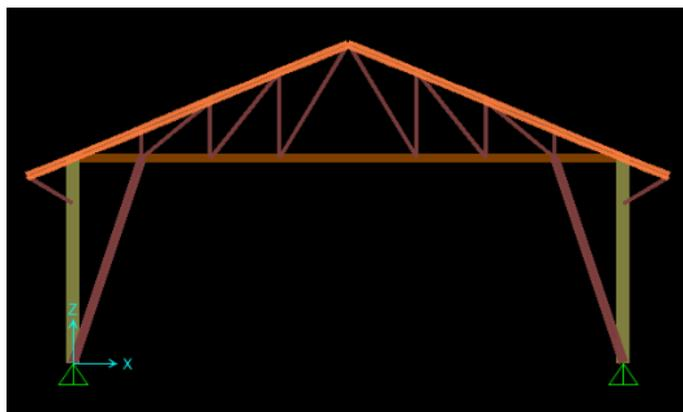
**Figura 3.13:** Pórtico transversal de la estructura. Fuente. Propia
