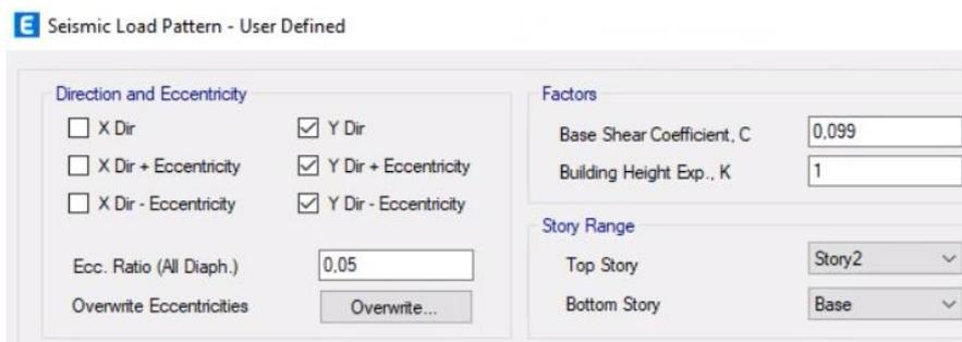
Ilustración 3.34 Patrón de carga sísmica en Y. [Pinzón & Villarruel, 2021]
