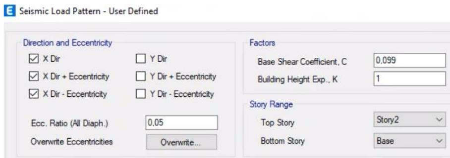
Ilustración 3.33 Patrón de carga sísmica en X. [Pinzón & Villarruel, 2021]
