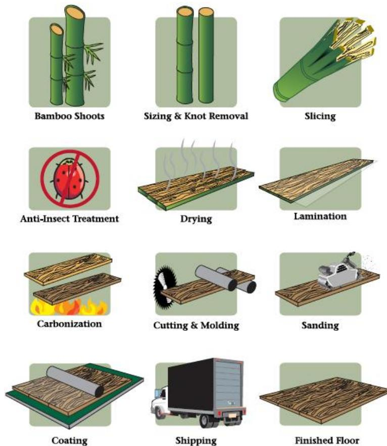
Ilustración 4.3 Fabricación de madera. [Bamboo Flooring Facts, 2020]
