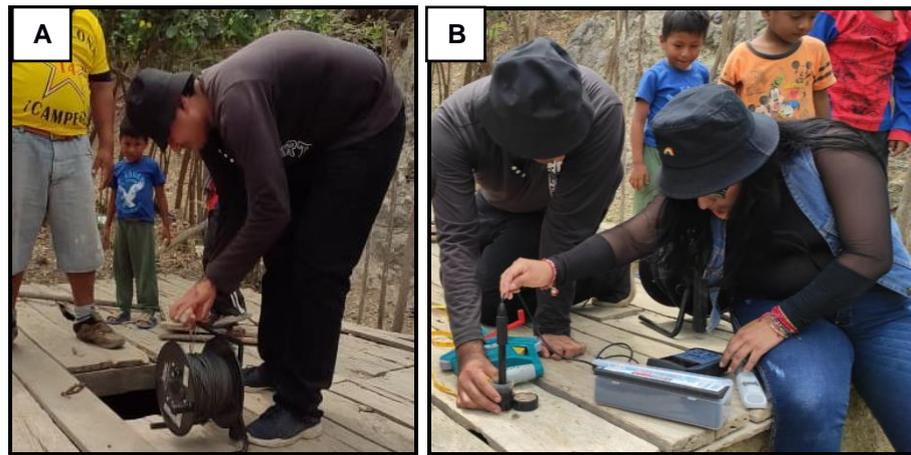
**Figura 2.3 A. Toma de nivel estático del pozo. B. Medición de parámetros físicos del agua de pozo**
