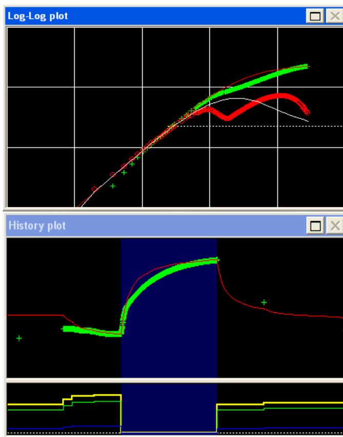
Figura 3.7 Ajuste del modelo log-log en la parte superior y ajuste de presión en la parte inferior realizado en Saphir.
