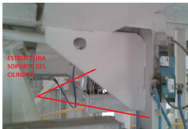
FIGURA 5.6 - ESTRUCTURA DE SOPORTE DEL CILINDRO NEUMÁTICO
