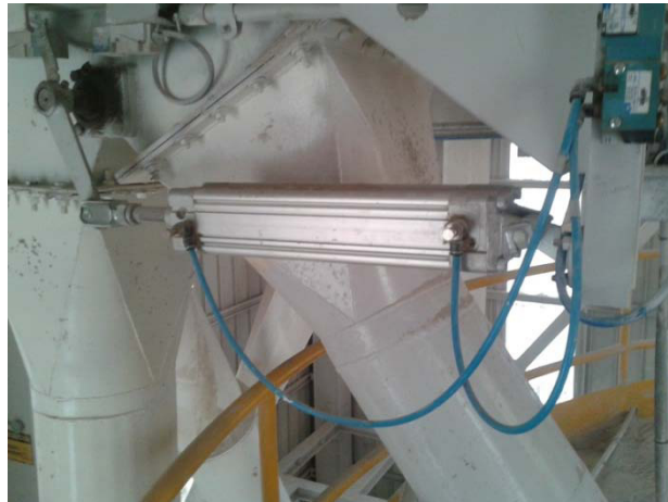
FIGURA 5.7 - CILINDRO NEUMÁTICO DOBLE EFECTO CON ACCESORIOS
