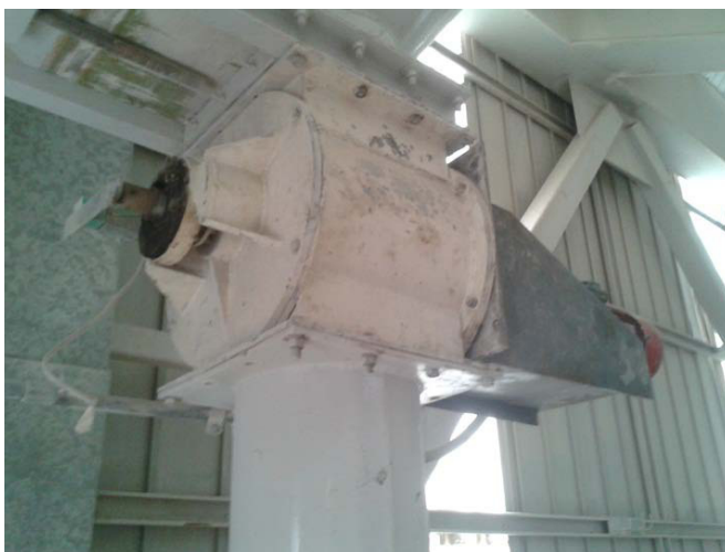
FIGURA 5.17 - VÁLVULA ROTATIVA ACOPLADA EN EL SITIO
