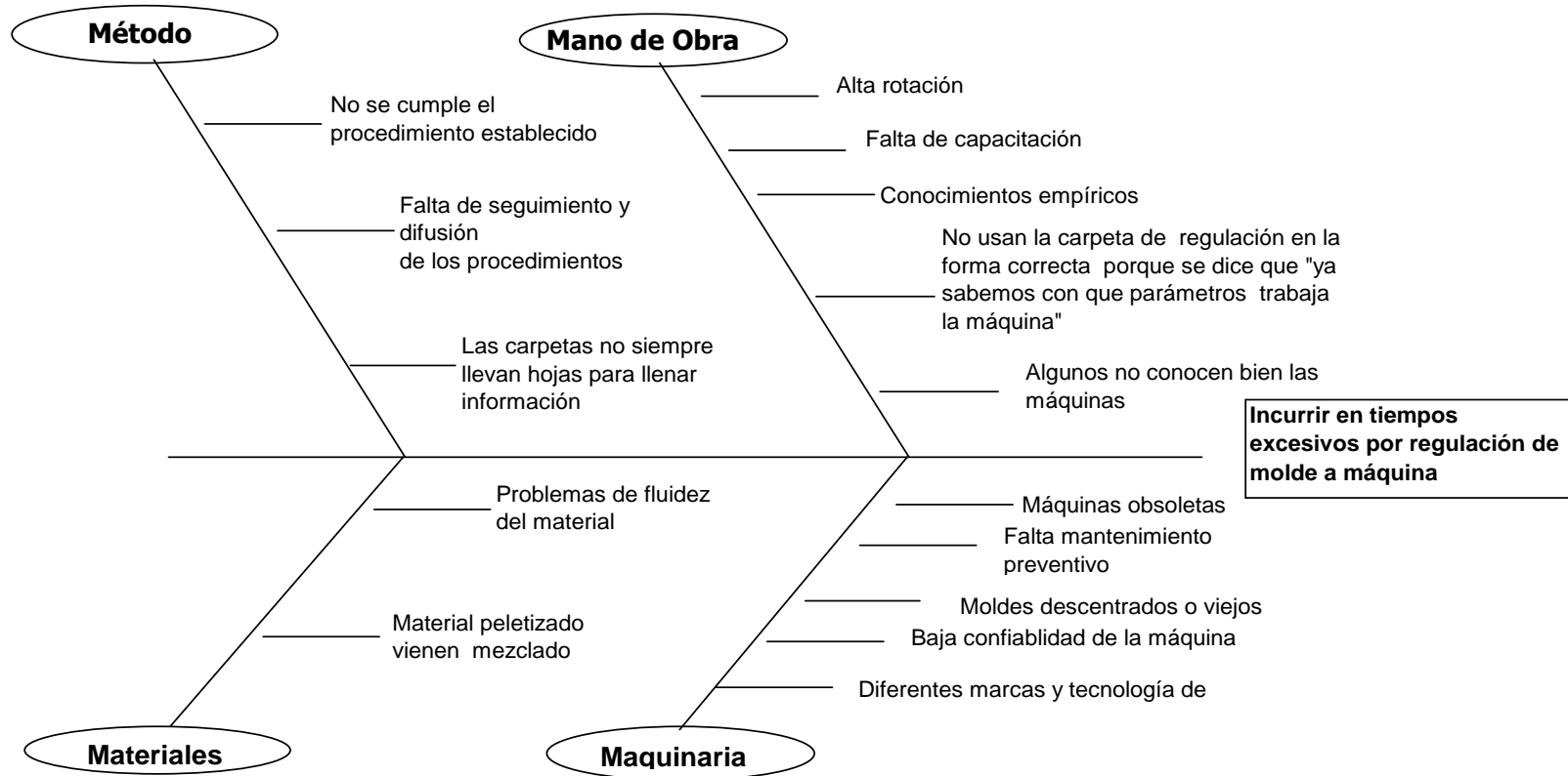
Figura 4.1 Diagrama causa efecto de la regulación molde máquina
