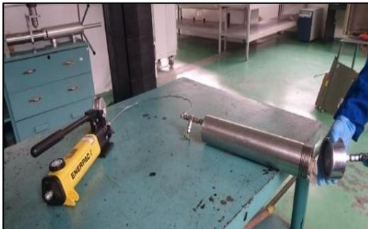
Fotografía 5. Sistema de saturación de la muestra de reservorio (plug).
