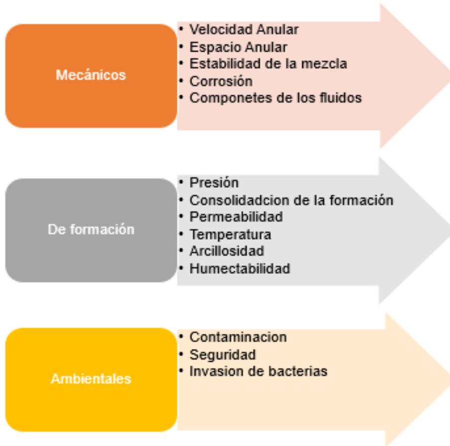
Figura 1-2: Elementos al seleccionar un fluido de completación (Autores)
