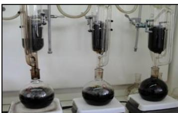
Fotografía 3. Sistema Soxlet para eliminación de hidrocarburo de muestras de roca reservorio.
