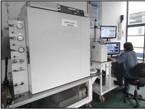
Fotografía 6. Sistema de ensayos de simulación de daños a la formación.
